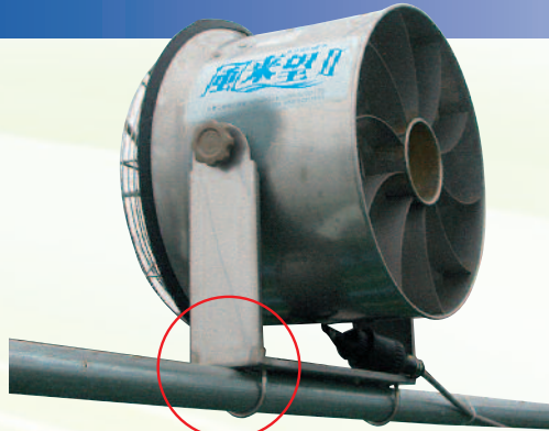
48.6パイプ取付参考写真
